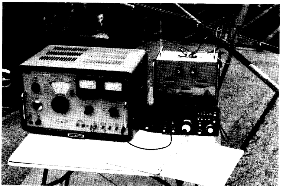
Fig. 14. Opstelling voor het meten van de impedantie aan de klemmen van een raam en aan de kabelzijde van een balun. De quad is hier nog in de Mk I-uitvoering met vishengels, zie deel 3 (foto: PAoSE).
